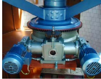
Links: Antriebsmotoren, rechts: Umlaufblenden vor der Optik.
