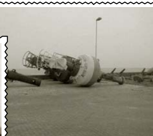
Leuchttonne Typ 81 L= 9,75 m, Du= 2,50 m, G= 5 to
