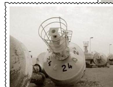
Leuchttonne Typ 81 L= 9,75 m, Du= 2,50 m, G= 5 to
